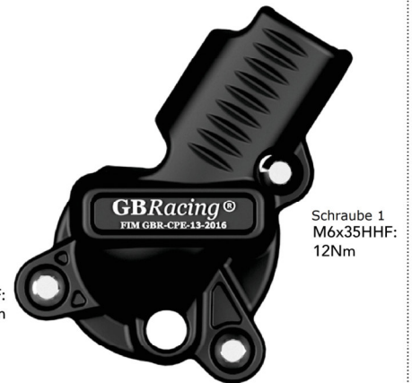
Schraube 2 M6x35HHF: 12Nm
